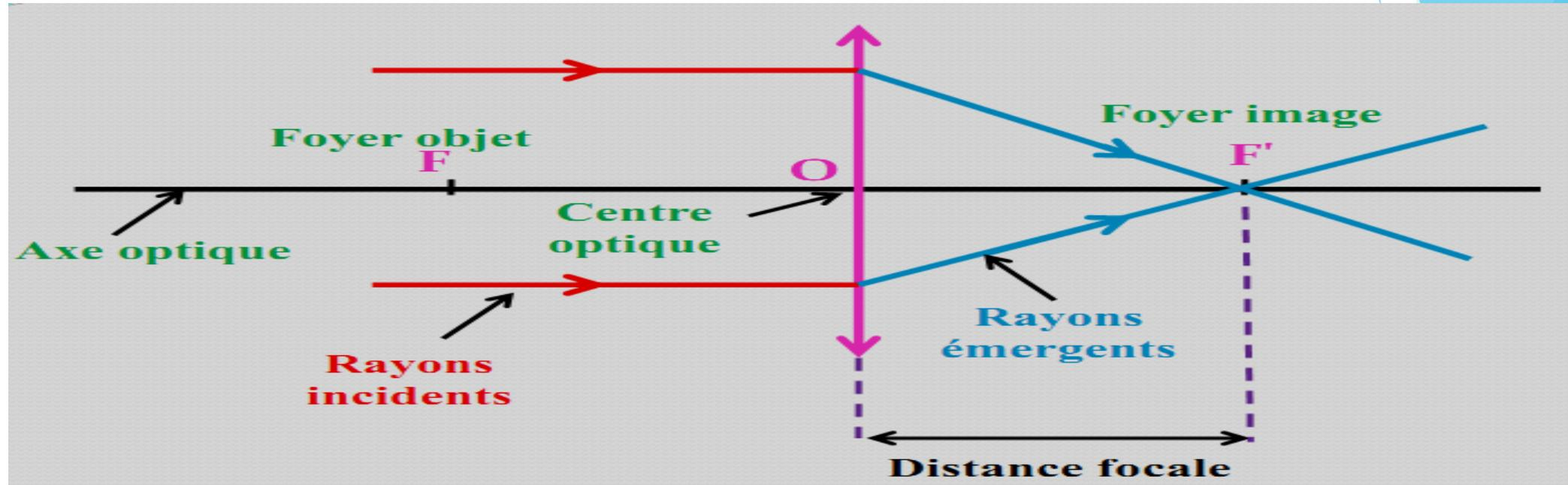
**Le foyer image noté  $F'$  d'une lentille convergente est le point où la lentille fait converger un faisceau de rayons parallèles à l'axe.**
