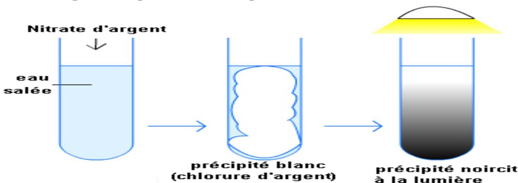
chlorure d'argent est une substance chimique qui réagit sous l'effet de la lumière
