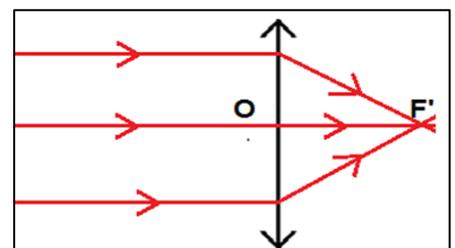
Si les rayons émergent parallèlement avec l'axe optique, alors ces rayons incidents passent par un point, symétrique de F' par rapport au centre optique, appelé foyer objet noté F.
