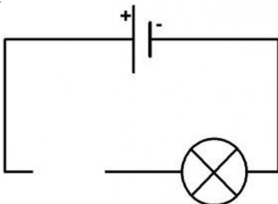
La lampe grillée ouvre le circuit et le courant électrique ne peut plus circuler.
