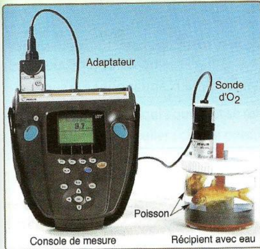
Document 4 : Schéma du montage pour mesurer la consommation d'O 2 du poisson rouge.
