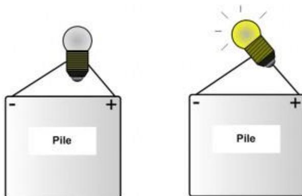
**Pour qu'une lampe s'allume, il faut relier, par des conducteurs, les deux bornes de la lampe avec les deux bornes de la pile.**
