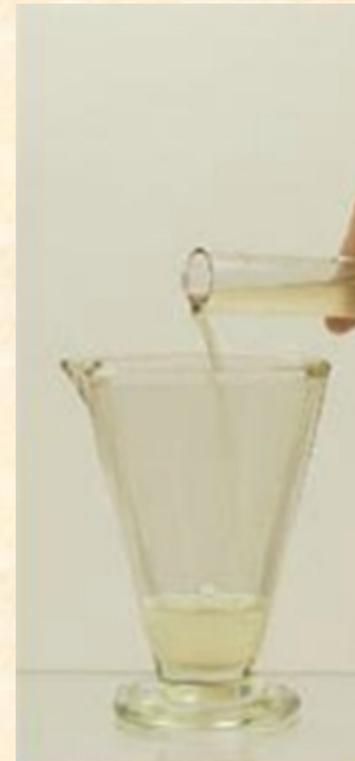
**Les particules solides et lourdes se déposent au fond du tube. Le liquide au-dessus du dépôt est limpide et plus clair.**
