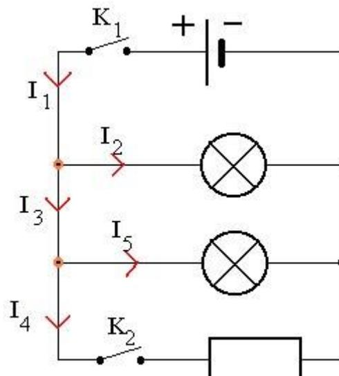
Utiliser la loi des nœuds pour trouver une égalité entre les intensités pour les 2 nœuds du circuit situés à gauche sur le schéma.
