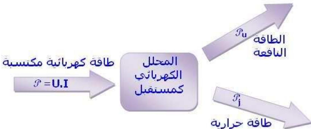
2 – القدرة الكهربائية المبذدة بمحفول جول :
