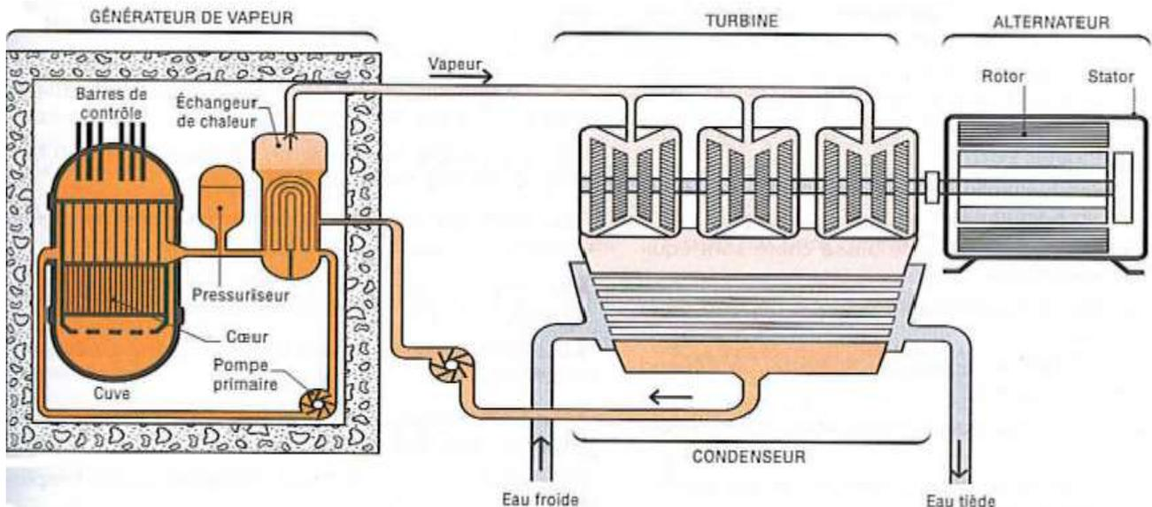
A l'intérieur du réacteur, ..... est le siège d'une réaction nucléaire qui produit une grande quantité de ..... Cette chaleur est continuellement évacuée hors du réacteur vers un échangeur de chaleur grâce à un fluide dit caloporteur.
