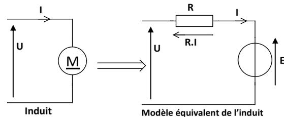
L'induit, soumis à une tension **U** dite tension d'induit, est constitué de conducteurs, de résistance **R**, traversés par un courant continu **I** dit courant d'induit. Il génère une f.é.m. ou une f.c.é.m. suivant qu'il fonctionne en génératrice ou en moteur.
