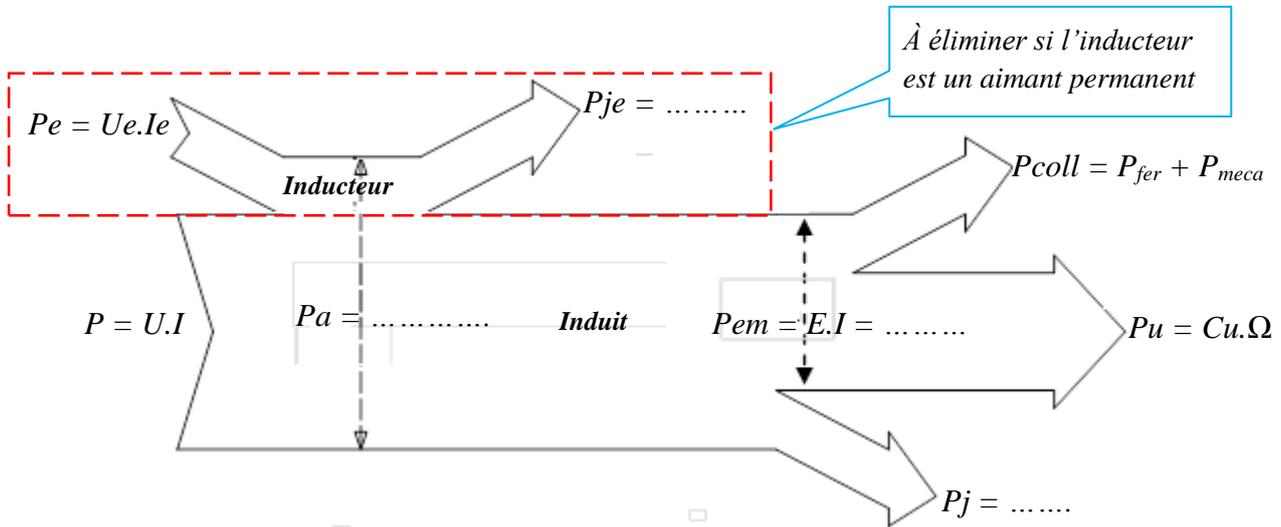
De plus, le rotor (matériau ferromagnétique) est en mouvement dans un champ magnétique, d'où l'apparition de **pertes magnétiques** notée  $P_{fer}$ .
