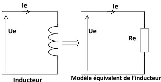
Lorsque l'inducteur n'est pas à aimants permanents, il est constitué de bobines en série traversées par un courant continu **I<sub>e</sub>**, appelé **courant d'excitation**.
