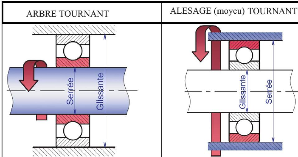
La bague intérieure **tournante** est montée.....
