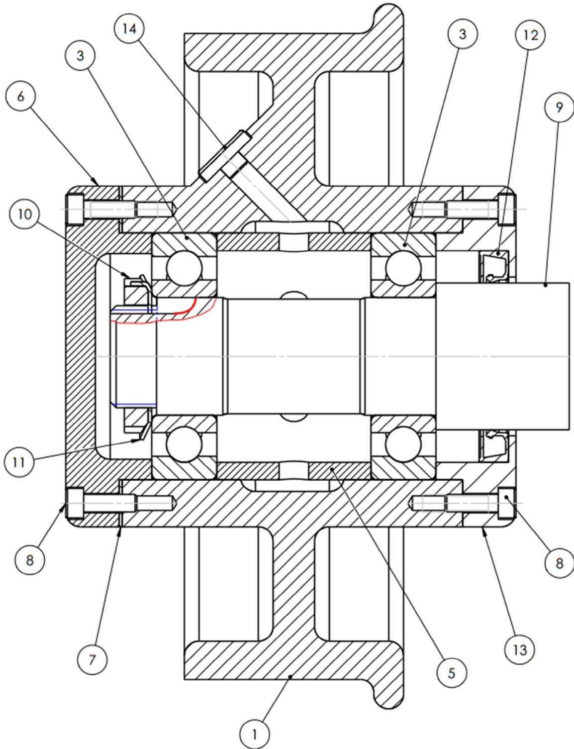
*Mettre en place les obstacles axiaux, Indiquer les ajustements.*
