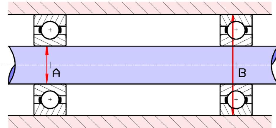
b) Indiquer le type d'ajustement en A et B
