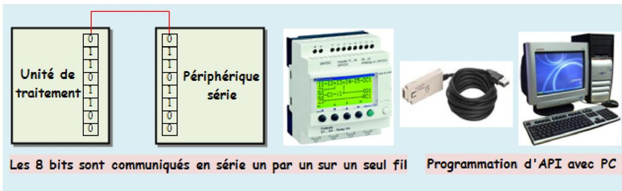
Dans une liaison série, on distingue plusieurs procédés et techniques de transmission, dans ce qui suit on s'intéresse à la liaison série asynchrone, en particulier avec les normes **RS232** et **RS485**.
