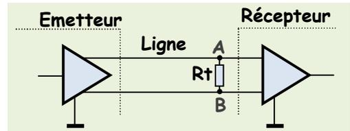
**Rt** : Résistance de terminaison de câble. Elle boucle la ligne sur son impédance caractéristique et minimise le bruit pour une meilleure transmission.
