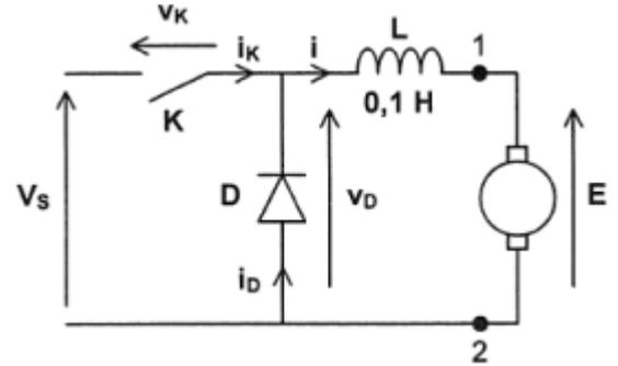
On considère (c'est une hypothèse simplificatrice) que la tension aux bornes du moteur est égale à sa f.é.m.  $E$  qui est proportionnelle à la vitesse de rotation du moteur :  $E = k.N$  avec  $k = 5,25.10^{-2} \text{ V}/(\text{tr.min}^{-1})$ .
