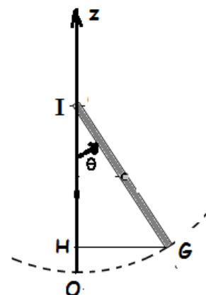
\* Energie cinétique:  $E_c = \frac{1}{2} J_{\Delta} \dot{\theta}^2$  avec  $J_{\Delta} = m.L^2$  et  $\dot{\theta}(t) = -\frac{2.\pi}{T_0} \theta_{\max} \cdot \sin\left(\frac{2.\pi}{T_0} .t + \varphi\right)$
