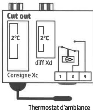
a. La chambre froide doit maintenir une température de conservation comprise entre 2°C et 4°C. Cette température est réglée par un thermostat d'ambiance dont les valeurs pré-réglées sont montrées sur le schéma ci-contre :
