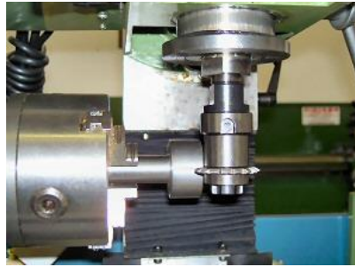
Figure 3 : Exemple de montage de la roue dentée (9') sur la machine (Vue de face)
