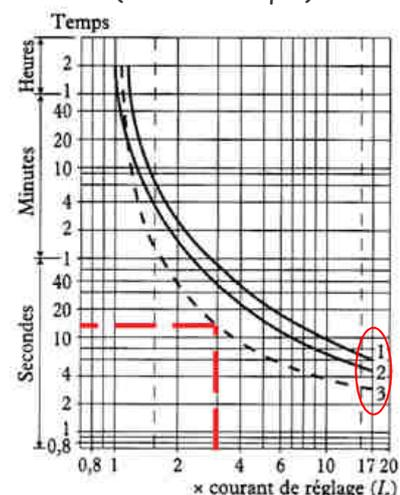
1. Fonctionnement équilibré 3 phases, sans passage préalable du courant (à froid).
