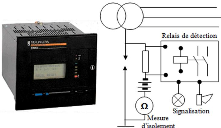
Cet appareil contrôle en permanence l'isolement du réseau.
