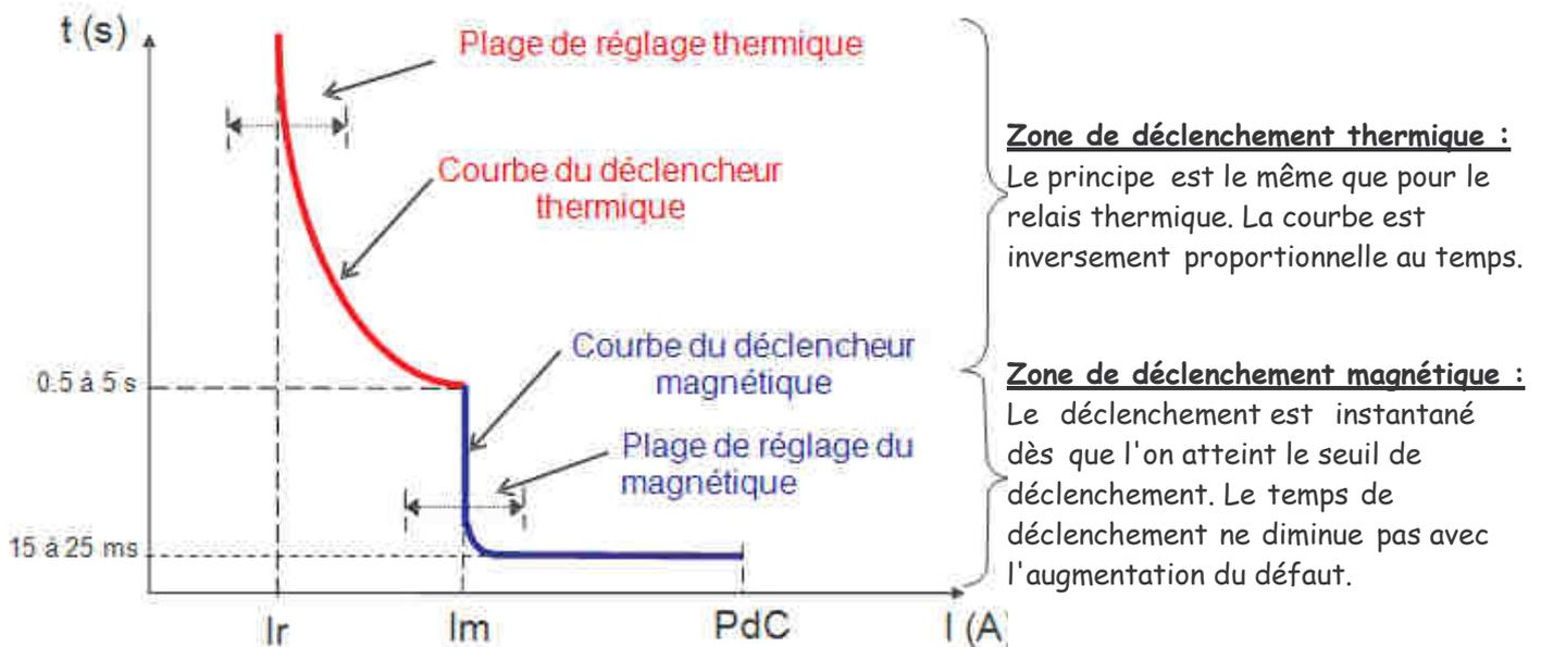
**Courant de réglage :**  $I_r$  ou  $I_{rth}$  c'est le courant maximal que peut supporter le disjoncteur sans déclenchement du dispositif thermique (de 0,7 à 1  $I_n$ ).
