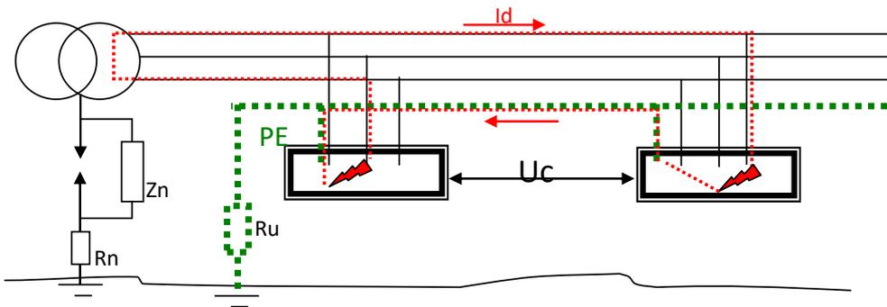
En cas de double défaut, il y a présence d'un fort **courant de court-circuit** (entre phase) et d'une **tension de contact ( $U_c$ ) dangereuse.**
