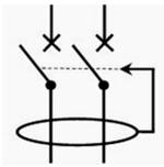
La **sensibilité** de ce DDR dépend de la tension limite de sécurité et de la **résistance de la prise de terre de l'installation ( $R_a$ )** :  $I\Delta_N = U_{limite}/R_u$
