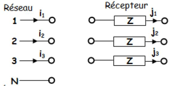
Le réseau et le récepteur peuvent se relier de deux façons différentes : en étoile ou en triangle.
