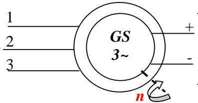
Rotor constitué d'électroaimants alimentés en courant continu et entraîné à la vitesse de rotation  $n$ .
