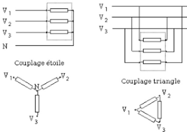
dans le couplage étoile l'intensité du courant de ligne égale à l'intensité du courant dans la phase, par contre dans un couplage triangle on a :  $I = \sqrt{3} J$
