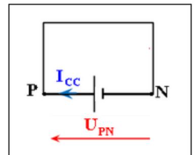
Pour mettre le générateur **en court-circuit**, on relie ses pôles par un fil métallique, dans ce cas la tension  $U_{PN}$  est nulle.
