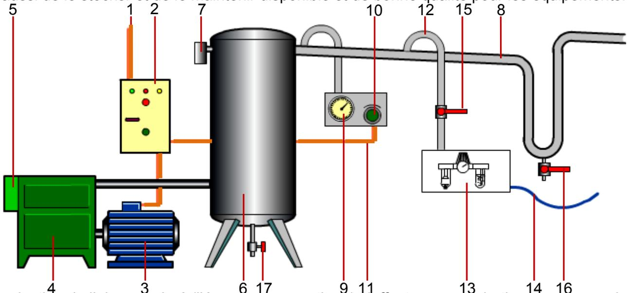
La production de l'air comprimé (l'énergie pneumatique) s'effectue par aspiration et compression de l'air extérieur. L'actionneur réalisant cette valeur ajoutée est le compresseur.
