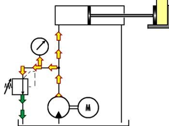
La pression va encore augmenter jusqu'à dépasser la limite de résistance de l'élément le plus fragile.
