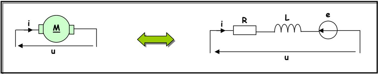
On suppose que le moteur est à flux constant, les frottements sont négligés et le fonctionnement est à vide.
