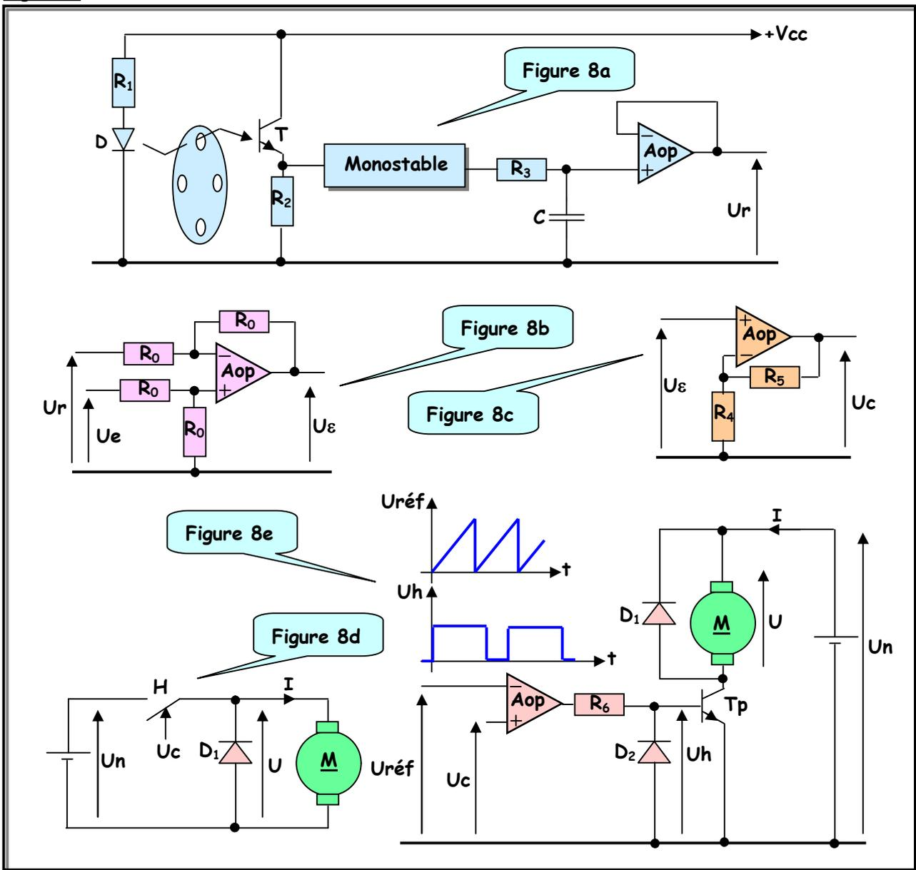
**633. Schéma fonctionnel du système régulé**
