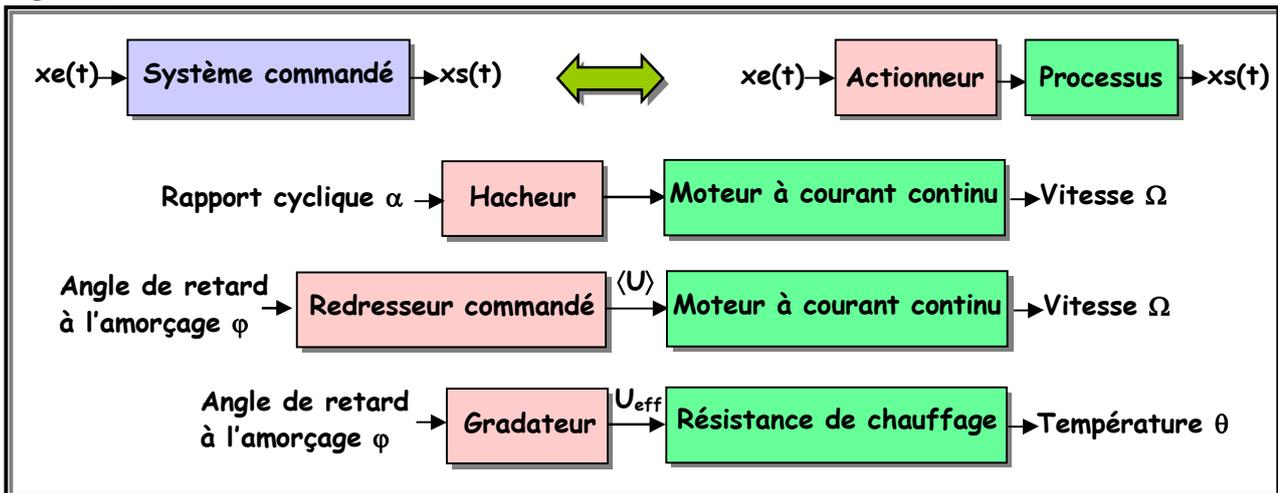
Un système commandé, dit aussi système en boucle ouverte, présente un inconvénient majeur d'être sensible aux perturbations qui affectent la grandeur de sortie.
