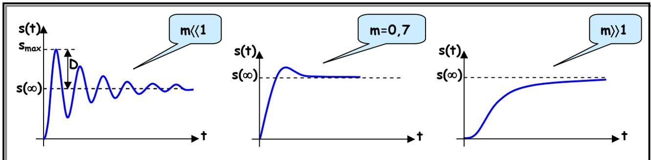
☑ Pour  $m \ll 1$  : Le système est pseudo oscillant ou oscillatoire amorti avec un dépassement important.
