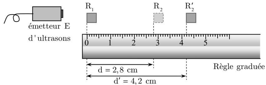
Figure A - 3: éloignement du récepteur  $R_2$
