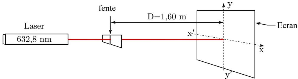
Figure B - 1: Schémas du montage expérimental
