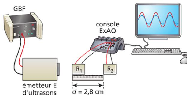
**Figure A - 1 : Schéma du dispositif expérimental**
