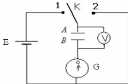
On utilise dans cette expérience un galvanomètre ou un ampèremètre à zéro central.
