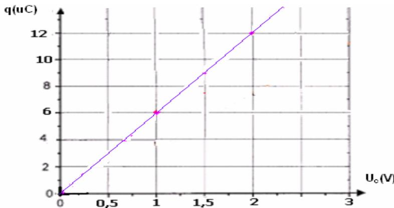
La charge q du condensateur est proportionnelle à la tension entre ses bornes, le coefficient de proportionnalité est une constante qui caractérise le condensateur notée **C**, est appelée : **capacité du condensateur**, elle s'exprime en farad (F).
