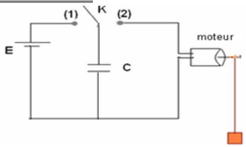
On bascule l'interrupteur K à la position (1) et on le laisse un temps suffisant pour que le condensateur soit chargé puis on le bascule à la position (2).
