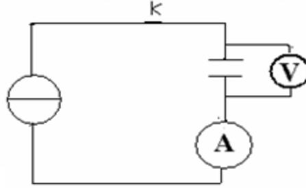
L'ampèremètre indique l'intensité du courant dans le circuit  $I_o = 0,3\mu A$  . On mesure la tension entre les bornes du condensateur après chaque cinq secondes et en utilisant la relation :  $q=I_o.t$  , on détermine la charge q du condensateur à chaque instant.
