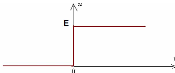
On monte en série un interrupteur ohmique de résistance R et un condensateur C et on obtient un dipôle RC puis on le soumet à un échelon de montant de tension à l'aide d'une source de tension continue.
