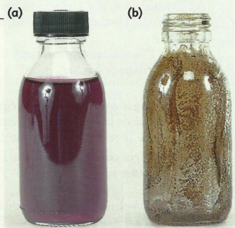
Doc. 5 Après quelques jours de stockage, la solution reste violette (a). Après plusieurs mois de stockage, un dépôt brun apparaît (b).
