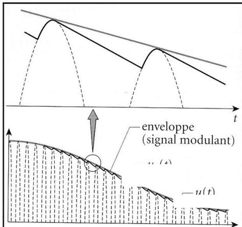
La détection ne sera efficace que si les caractéristiques de  $R_1$  et de  $C_1$  sont bien accordées à la fréquence du signal à démoduler : la constante de temps  $\tau_1 = R_1 C_1$  du circuit détecteur doit être très supérieure à la période de la porteuse et inférieure à la période du signal modulant.
