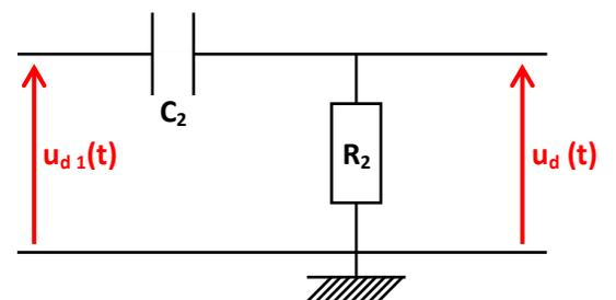
▪ On ajoute au montage précédent un filtre  $R_2 C_2$  tel qu'indiqué sur le circuit suivant :
