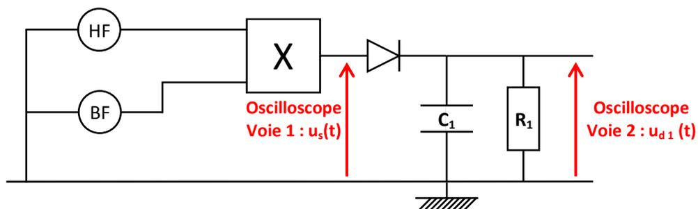
3. Sachant que  $R_1 = 47 \text{ k}\Omega$ , comparer la constante de temps  $\tau_1$  du circuit de détection  $R_1 C_1$  à la période de la porteuse  $T_p$ .
