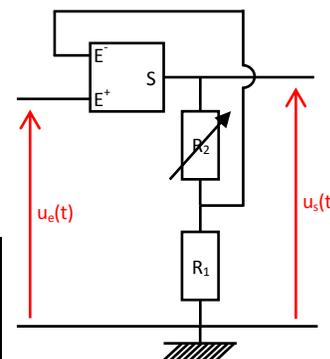
Sur le poste de radio, le bouton volume permet de faire varier la valeur d'une résistance par rapport à l'autre, et donc de régler le facteur d'amplification du signal.
