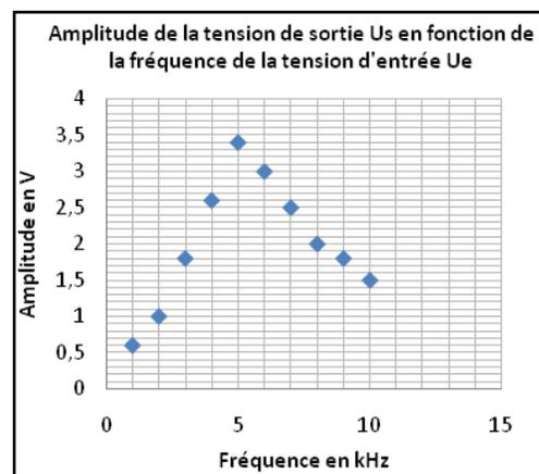
On appellera **bande passante à 3 décibels** la gamme de fréquence pour lesquelles l'amplitude est supérieure ou égale à  $\frac{U_{\max}}{\sqrt{2}}$ .
