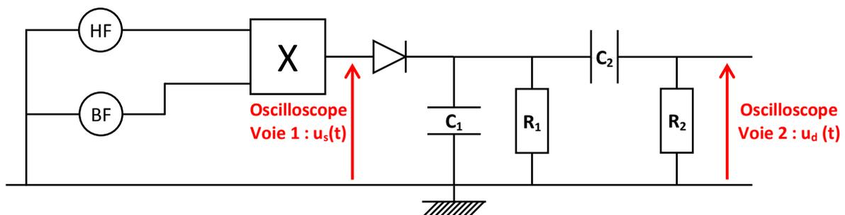
Il faut, pour que le filtre soit efficace, que la constante de temps du filtre soit très supérieure à la période du signal modulant ( $\tau_2 \gg T_{\text{signal modulant}}$ ).
