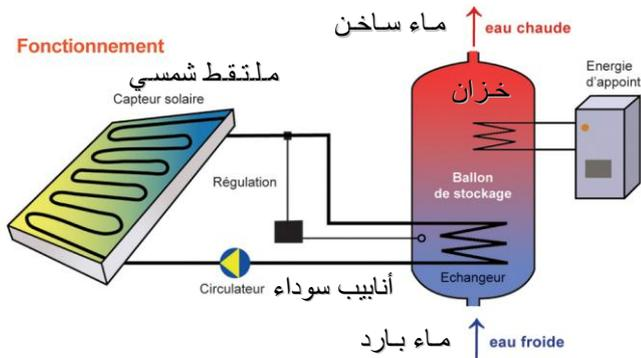
يتكون الملتقط الشمسي المسطح من إطار مغطى بزجاج شمسي يلتقط أشعة الشمس ويخزنها داخليا عن طريق مبدأ الانحباس الحراري. هذه الحرارة التي تتراوح درجاتها ما بين  $50^{\circ}$  إلى  $80^{\circ}$  ترسل إلى الماء الذي يمر عبر أنابيب نحاسية سوداء ثم إلى الخزان من أجل استعمالها في الحمام أو المسبح، كما يتكون من مواد عازلة تمنع تسرب الحرارة إلى الخارج.
